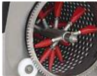
6. ábra: A gumilapátos bogyózómotolla felépítése (Forrás: https://keszenlet.hu/boraszat/termek/ )
