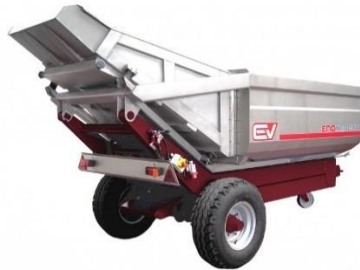
3. ábra: Enoveneta hidraulikus emelésű vibrációs kihordású szüretelőkocsi (Forrás: https://keszenlet.hu/boraszat/termek/ )
